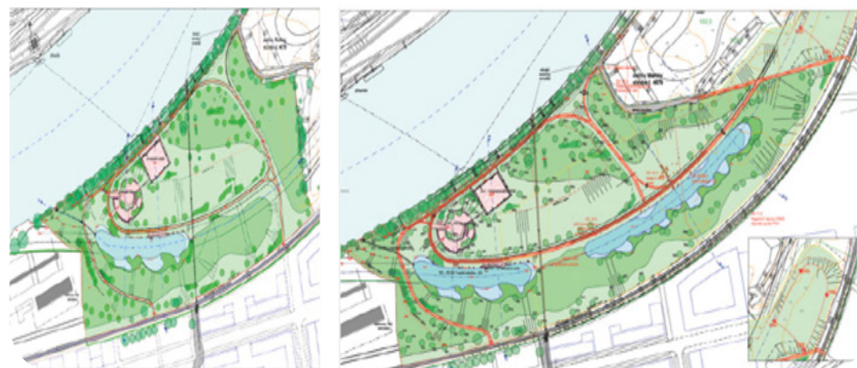
Obr. 15: Stavba č. 4679 „Maniny – PPO, snížení nivelety Karlín“ etapa 0001 (poldr s oddychovou zónou) a etapa 0002 (rozšíření poldru), fáze přípravy k 11/2016: pravomocná vodoprávní a stavební povolení / Zdroj: VRV Praha
